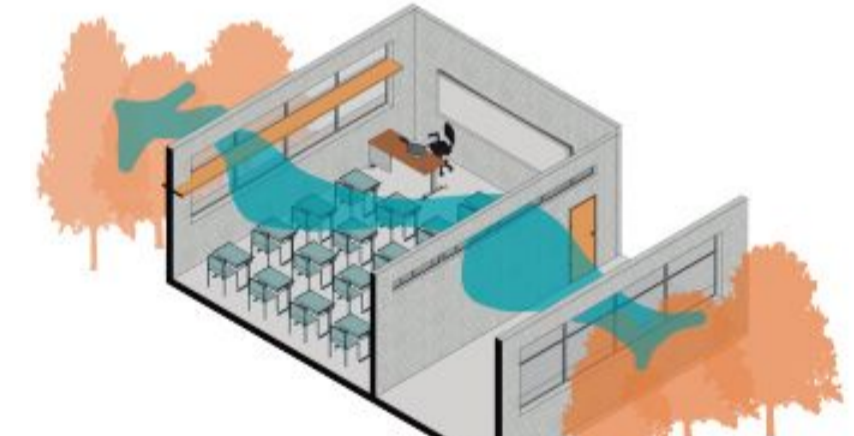
VENTILAÇÃO CRUZADA HIGIÊNICA ENTRE DOIS AMBIENTES EXTERNOS - LIMPOS PASSANDO POR UM AMBIENTE CONTAMINADO
